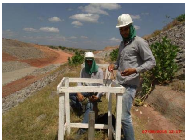
Foto 28 – Túnel Cuncas I, leitura do inclinômetro Nº1 – WBS 1410.
