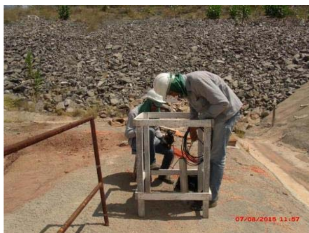
Foto 27 – Túnel Cuncas I, leitura do inclinômetro Nº2 – WBS 1410.
