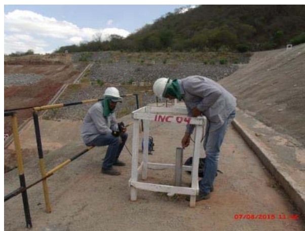
Foto 24 – Túnel Cuncas I, leitura do inclinômetro Nº4 – WBS 1410.
