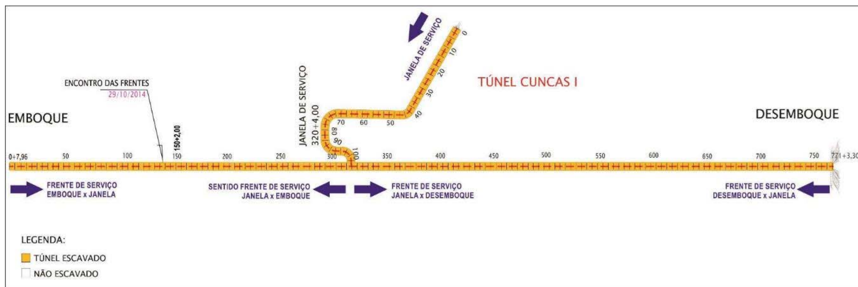
Figura 6: Planta esquemática com as frentes de escavação - Túnel Cuncas I
