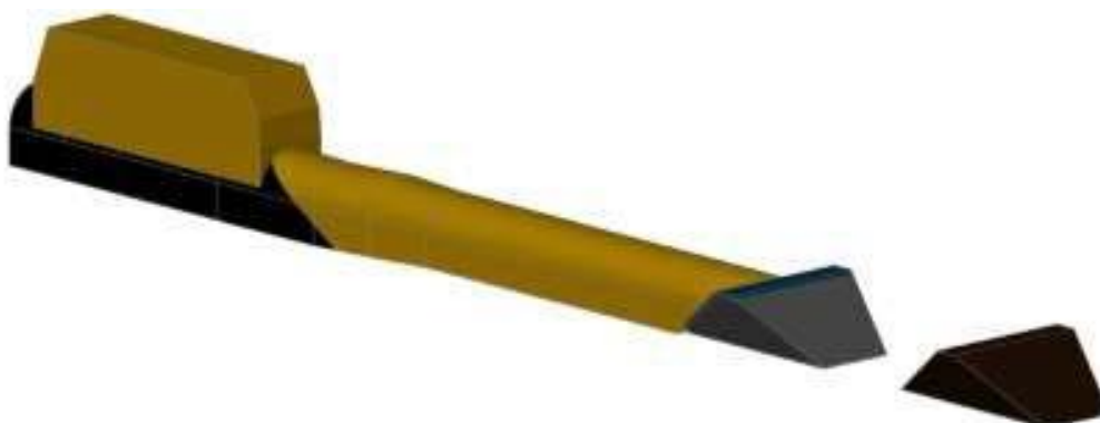
Figura 27 - Vista Isométrica do enchimento do túnel (Fonte - IRSF-PL-QUANT-ECI-2012 –Opção 4 – Preenchimento do túnel)
