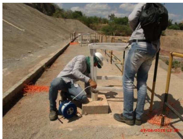
Foto 26 – Túnel Cuncas I, leitura do piezômetro. – WBS 1410.
